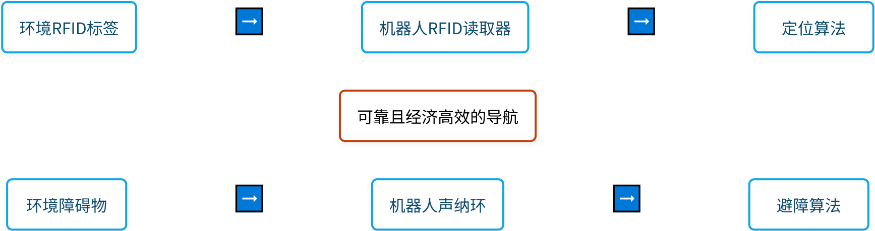
图3: RFID+声纳系统协同工作流程示意
